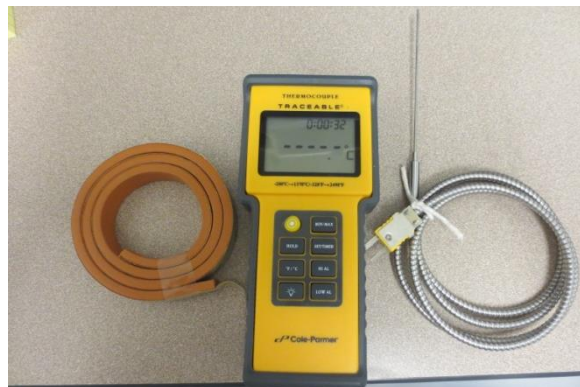
de gauche à droite : ruban en mousse à cellules, thermomètre et sonde à embout en aiguille Photo utilisée avec la permission du chef T. MacDonald, CCV
